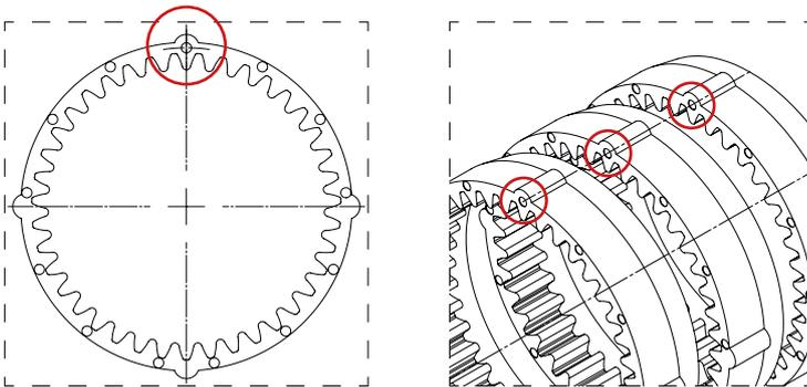
Montageausrichtung der Getriebeaußenringe.
