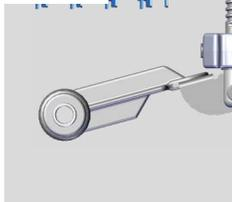
**Standfuß:** Der Standfuß ermöglicht das sichere Abstellen des Lamellenreinigers. Zudem dient er in der zurückgeklappten Position als Griff zum Halten.
