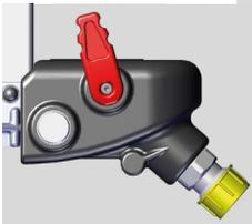
**Start-Stopp-Schalter:** Der Start-Stopp-Schalter gibt den Wasserfluss zu den Turbinen frei oder sperrt ihn wieder.
