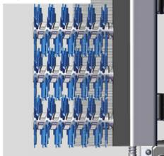
**Spritzschutz:** Der Spritzschutz reduziert den Wassernebel Richtung Bediener und erhöht die Abschwemmwirkung (optional).
