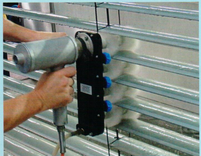
Am besten reinigen laut VDS-Test Geräte mit rotierenden Bürstenwalzen. Erhältlich sind elektro- oder wasserhochdruckangetriebene Systeme.
