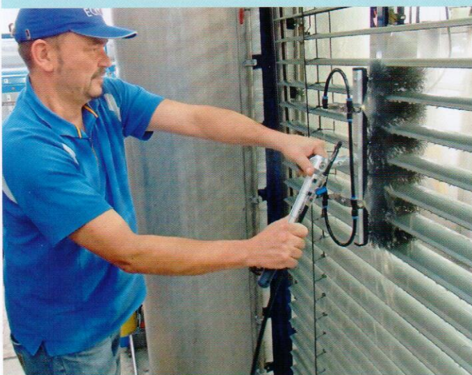
Systeme für die mobile Reinigung von Außenjalousien im Praxistest: Der VDS hat verschiedene Geräte unter die Lupe genommen.
