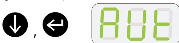
Nach einiger Zeit wird der berechnete CAL-Wert (z.B. C50) angezeigt und die Steuerung ist betriebsbereit. Drücken Sie die Eingabetaste, um die Kalibrierungseinstellung zu beenden.
