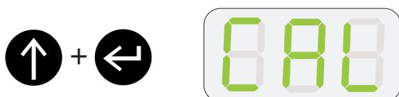
Um die automatische Kalibrierungseinstellung auszuwählen, drücken Sie die Pfeiltaste solange nach unten, bis AUT angezeigt wird. Drücken Sie die Eingabetaste, um die automatische Kalibrierung (beginnt bei C99) zu starten.
