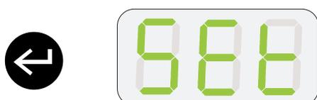
Der CAL-Wert kann manuell eingestellt werden, indem Sie die gleichen Schritte wie oben ausführen. Passen Sie den CAL-Wert durch Drücken des Pfeils nach oben oder unten an. Zum Aktivieren oder Deaktivieren der niedrigen Batterieabschaltung (die Ihre Pumpe stoppt, wenn die Batteriespannung unter 10,5 V liegt), halten Sie die Pfeiltaste nach unten und die Eingabetaste gedrückt.
