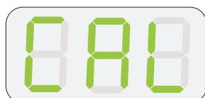
Um die automatische Kalibrierungseinstellung auszuwählen, drücken Sie die Pfeiltaste solange nach unten, bis AUT angezeigt wird. Drücken Sie die Eingabetaste, um die automatische Kalibrierung (beginnt bei C99) zu starten.
