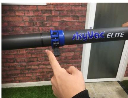
Stecken Sie die Stange NUR bis zur Anschlagmarkierung ein.
