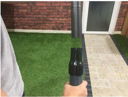
Verbinden Sie das „Verbindungsstück Saugschlauch und Stange“ mit dem ELITE Stangenelement mit Entlüftungsöffnung (Handstück/ Basisstange).
