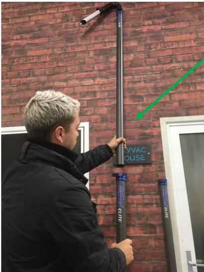
Stecken Sie die Stangen in Anlehnung an ein Gebäude ineinander. Bringen Sie zuerst den Reinigungsaufsatz an der obersten Stange an und stecken Sie dann die Stangen auf die gewünschte Höhe ineinander. Das Stangenelement mit Entlüftungsöffnung ist Ihr „Handstück“ und wird als Basisstange verwendet.
