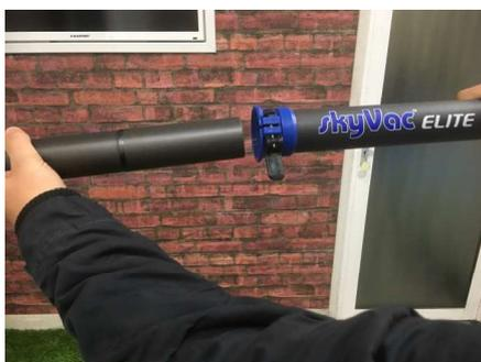
Öffnen Sie die Klemme und stecken Sie das Stangenelement ein.
