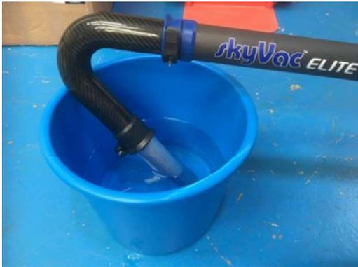
Während der Reinigung können nasse oder feuchte Dachrinnenverschmutzungen an der Innenseite Ihrer ELITE-Stange haften bleiben und das Gewicht der Stangen wird zunehmen. Um dies zu beheben, legen Sie den Reinigungsaufsatz in einen Eimer mit Wasser und saugen Sie eine kleine Menge Wasser auf.
