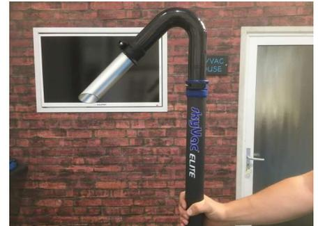
Wählen Sie Ihren Reinigungsaufsatz aus, führen Sie ihn in den Schwannenhals und stellen Sie die Spannung der Klemme entsprechend ein.
