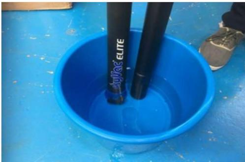
Reinigen Sie nach jedem Arbeitseinsatz das Innere der ELITE-Stange sowie die Schläuche, indem Sie einen halben Eimer Wasser einsaugen und anschließend leeren.
