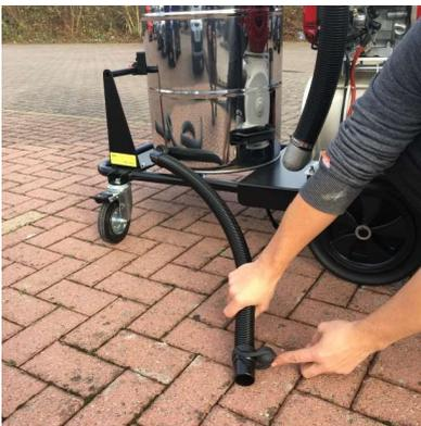
Der Siebkorb fängt und sammelt Schmutz, wie Blätter, Rasen, Moosreste etc. auf und das eingesaugte Wasser sickert hindurch auf den Boden der Trommel. Um das Wasser abzulassen, schalten Sie den Motor ab, lösen den Ablaufschlauch von der Trommel und entfernen die Schlauchkappe. Nun können Sie das Wasser abfließen lassen. Zum Entsorgen des im Siebkorb angesammelten Schmutzes nehmen Sie diesen aus der Trommel heraus und kippen Sie den Inhalt aus.
