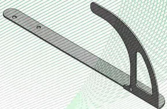
Bild 2: Sicherheitsdachhaken Typ B,
