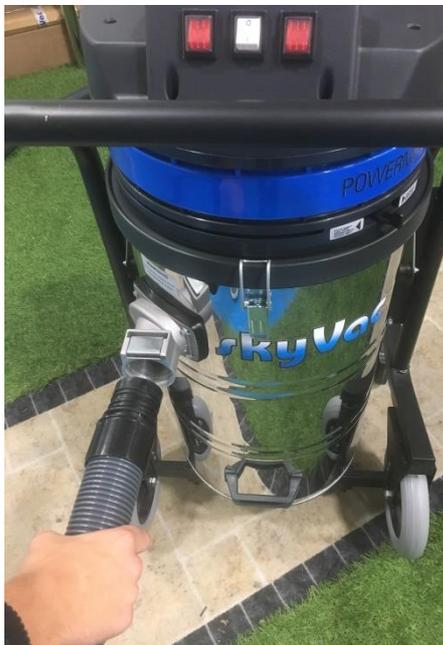
Stecken Sie die lange, flexible Tülle am Saugschlauch in den Eingang am Sauger.
