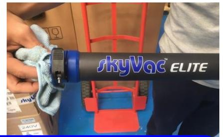
**Reinigen Sie die Stangen-Elemente nach jeder Anwendung. Gerade die Steckverbindung sollte immer sauber sein um Schäden und übermäßige Abnutzung zu verhindern.**
